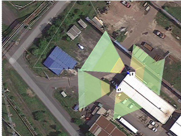
Obrázek 32 – Znáznornění zorného pole kamer
