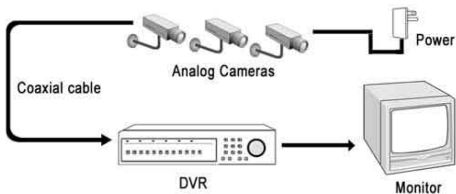
Obrázek 2 – Schéma analogového systému DVR. [3]
