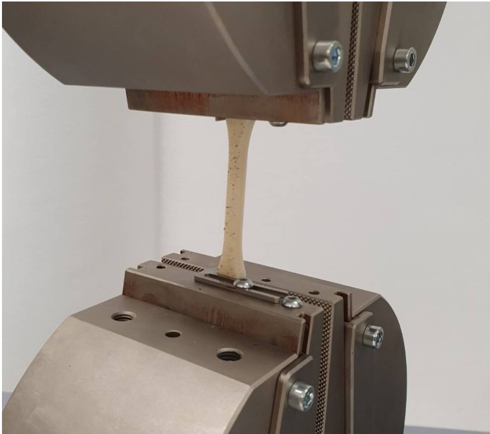
Obrázek 33 Detailní pohled na upnutí – zkouška tahu
