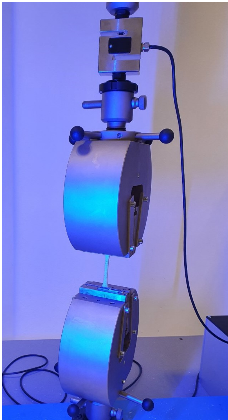
Obrázek 32 Upnutí testovacího vzorku při měření tahové zkoušky Detailní pohled na středovou část čelistí je následně zobrazen na obrázku 33.
