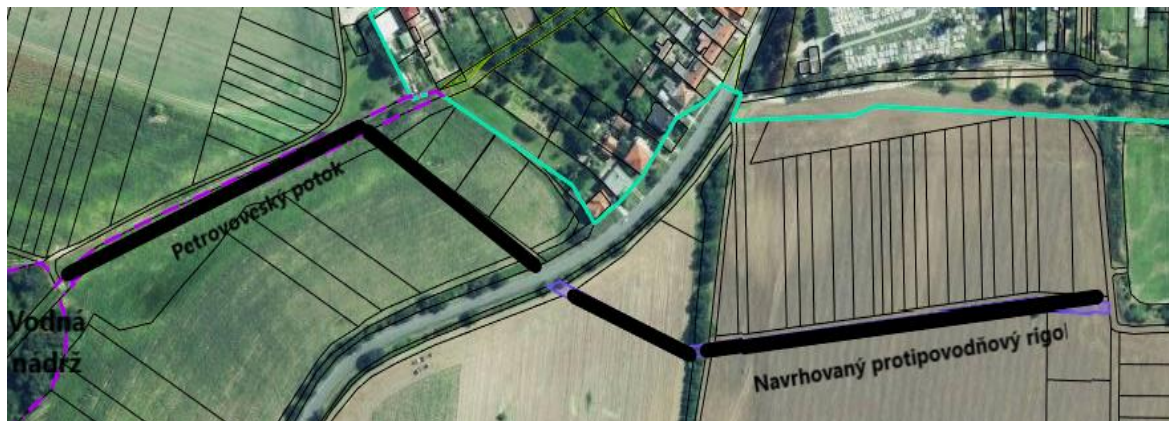
Obrázok 23 Zaústenie dažďovej vody do Petrovoveského potoka a Vodnej nádrže. [24]
