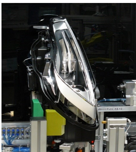
Obrázek 16 Skupina pouzdra po elektrické zkoušce (interní zdroj)
