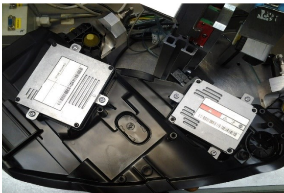
Obrázek 9 Pouzdro s řídicí jednotkou a předřadníkem (interní zdroj)
