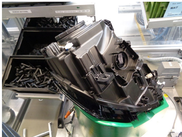
Obrázek 18 Světlomet po vložení těsnění a odvětrávacích kolínek (interní zdroj)
