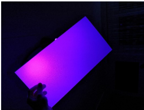
Obr. 49: Zkouška prosvitu plexiskla se zdrsňenou plochou
