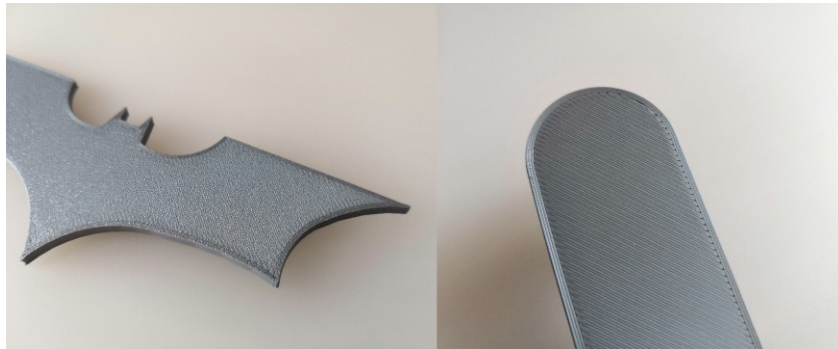
Obr. 47: První vrstva PEI povrch nalevo, hladký povrch napravo
