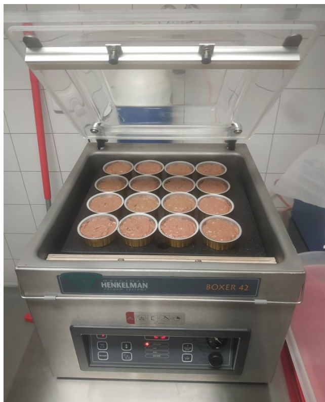
Obrázek 10: Vakuování vzorků pomocí baličky
