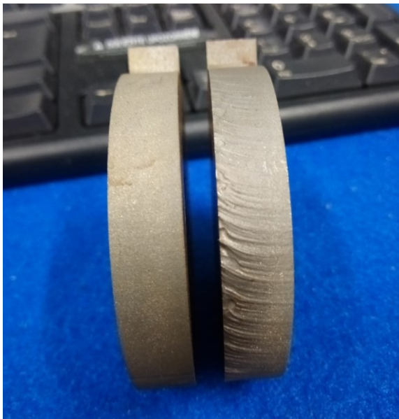
Obr. 27 – srovnání jakosti povrchu vzorků Q1 (vpravo) a Q5 (vlevo)
