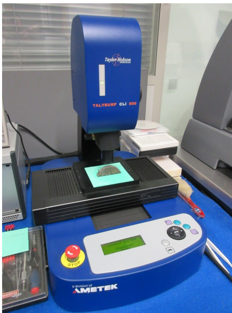
Obr. 29 – bezkontaktní drsnoměr Taylor Hobson Talysurf CLI 500
