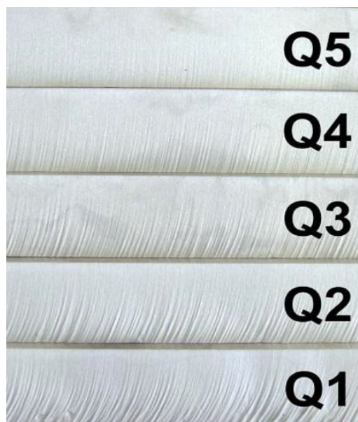
Obr. 17 – stupně kvality řezu vodním paprskem [18]
