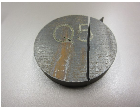
Obr. 28 – vzorek Q5 po provedení řezu
