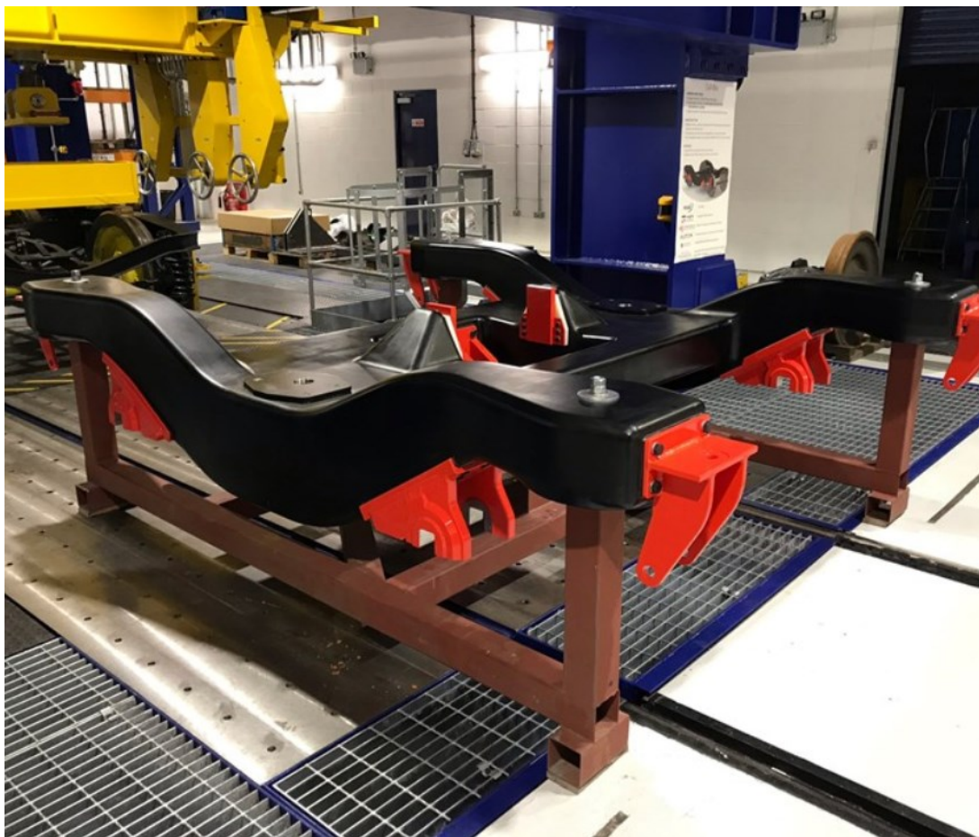
Obr. 23: Podvozek vagonu z recyklovaného uhlíkového vlákna [32]
