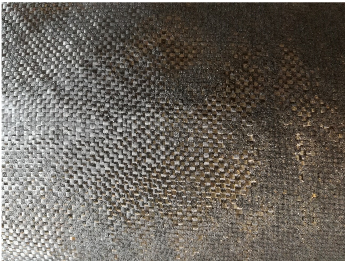
Obr. 39: Hybridní tkanina aramid-uhlík po provedené recyklaci při 370°C a setrvání na této teplotě po dobu 90 minut.
