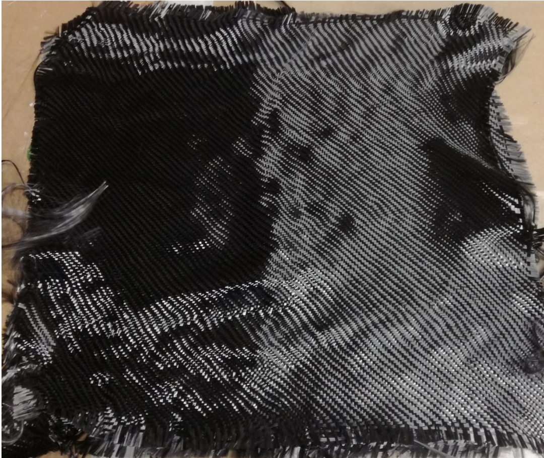
Obr. 37: Recyklované uhlíkové vlákno při teplotě 550°C po dobu 30 minut
