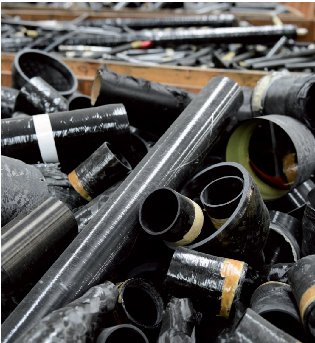
Obr. 4: Skládka polymerního odpadu z uhlíkových vláken [26]
