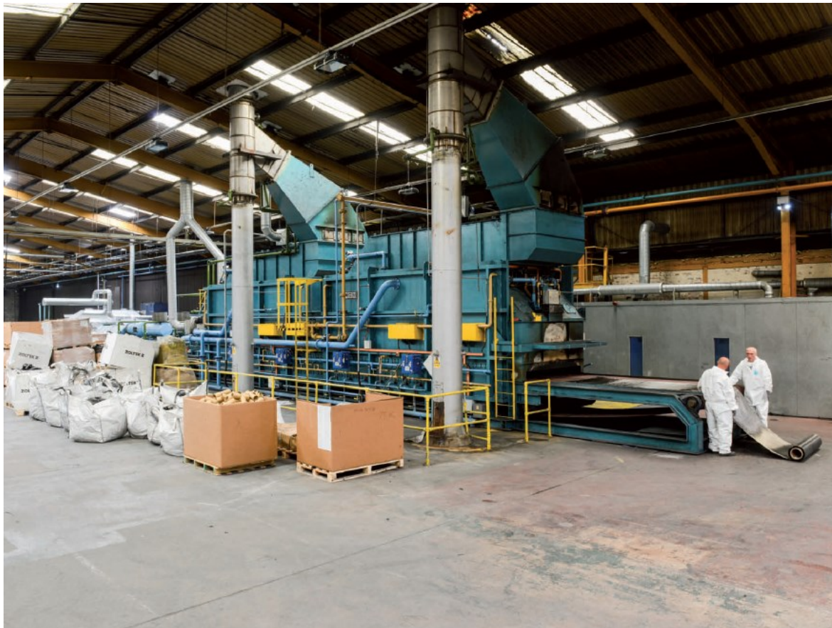
Obr. 20: Pyrolýzní linka společnosti ELG Carbon Fibre [26]
