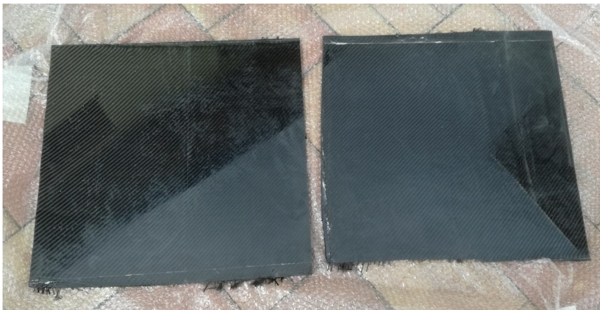
Obr. 32: Kompozitní uhlíkové desky před recyklačním procesem
