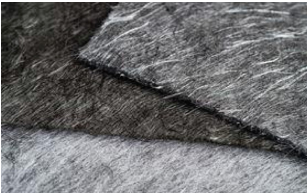
Obr. 24: Netkaná rohož z recyklovaných uhlíkových vláken společnosti ELG Carbon [32]
