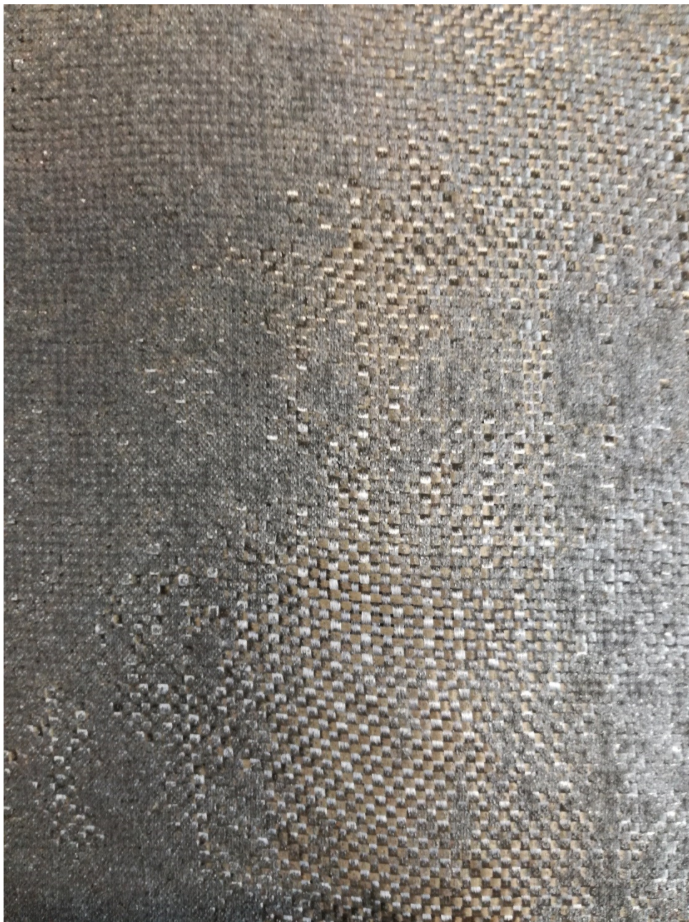
Obr. 38: Hybridní tkanina aramid-uhlík po provedené recyklaci při 370°C a setrvání na této teplotě po dobu 45 minut.
