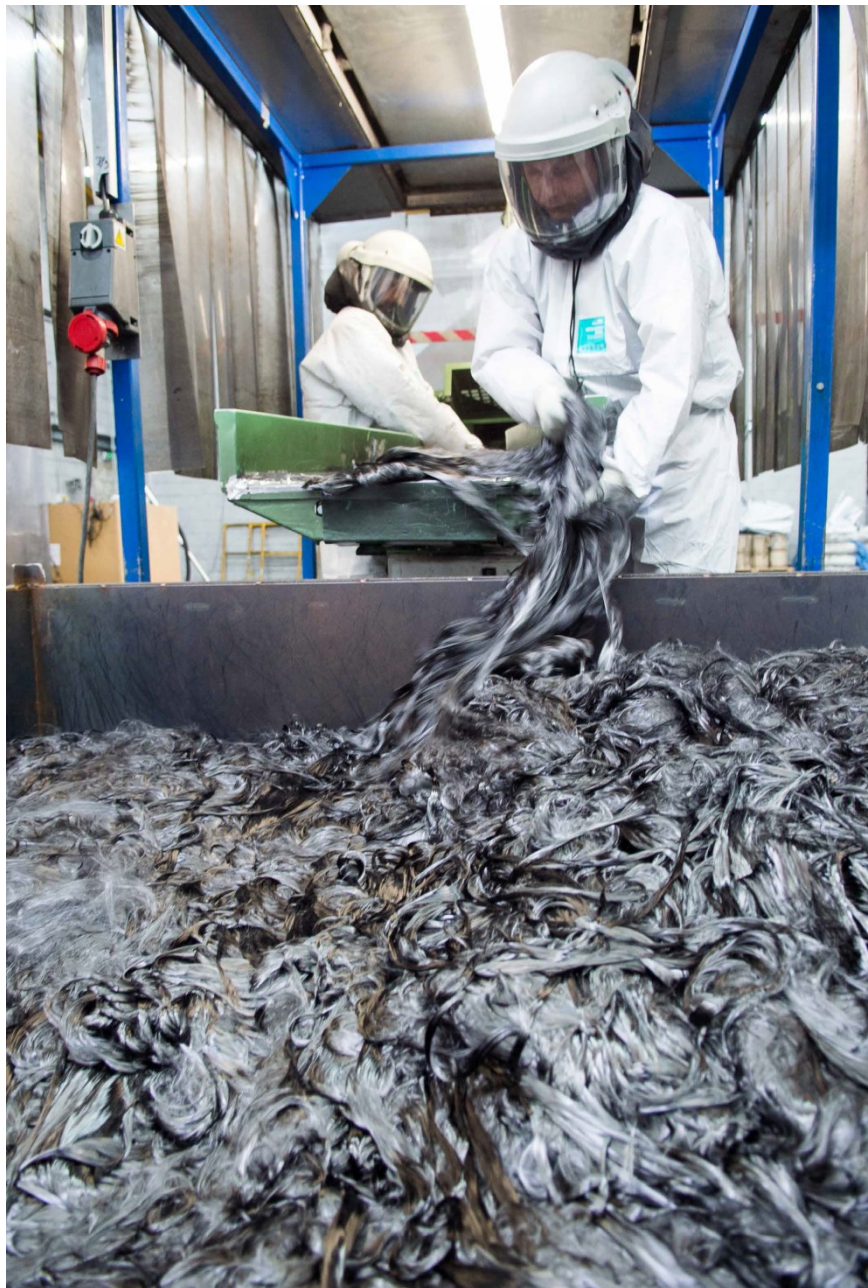
Obr. 6: Recyklovaná uhlíková vlákna pomocí pyrolýzy [7]
