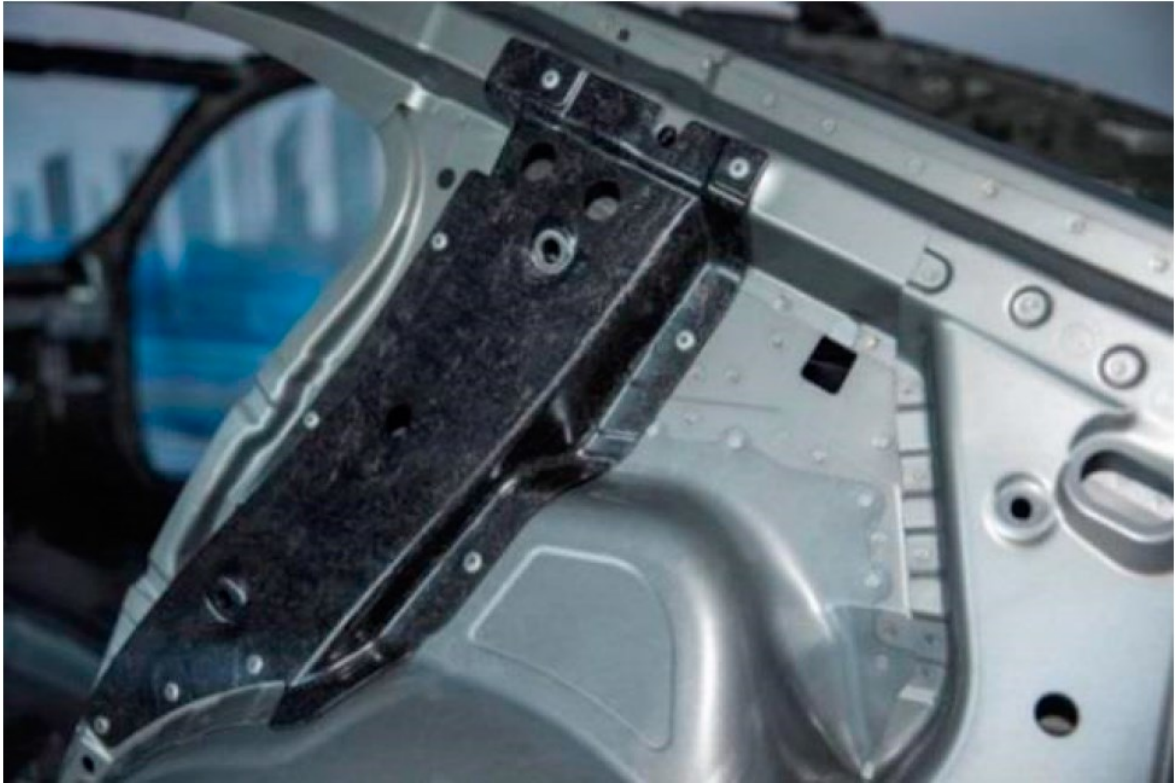
Obr. 21: C-sloupek v automobilu BMW řady 7, vyztužený recyklovaným uhlíkovým vláknem vyrobený metodou SMC [28]
