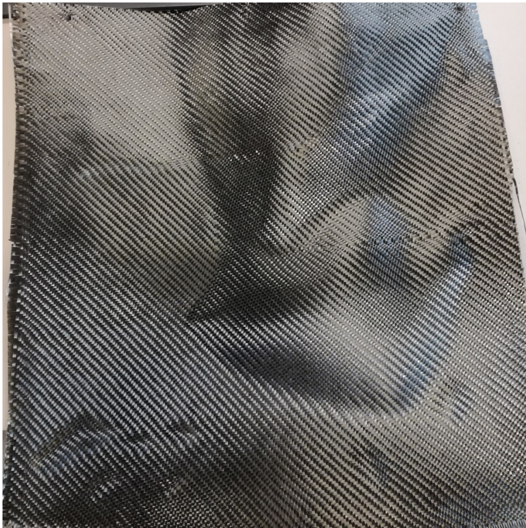
Obr. 36: Recyklované uhlíkové vlákno při teplotě 450°C po dobu 30 minut
