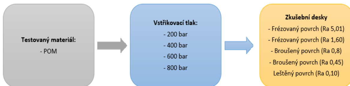
Obr. 35 Schematicky znázorněné možné přípravy zkušebních vzorků
