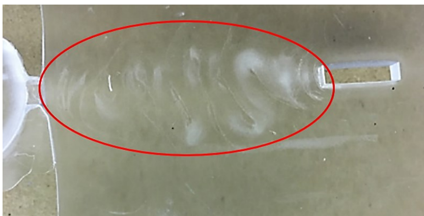
Obr. 29: Tryskový tok na výstřiku z materiálu PC. [25]
