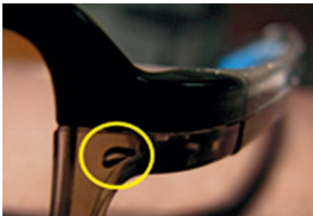
Obr. 16: Propadlina na výstřiku. [23]
