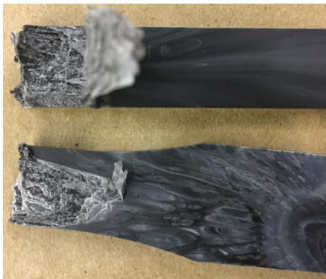
Obr. 18: Delaminace na výstřicích. [25]
