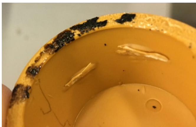
Obr. 19: Spálená místa na výstřiku. [25]
