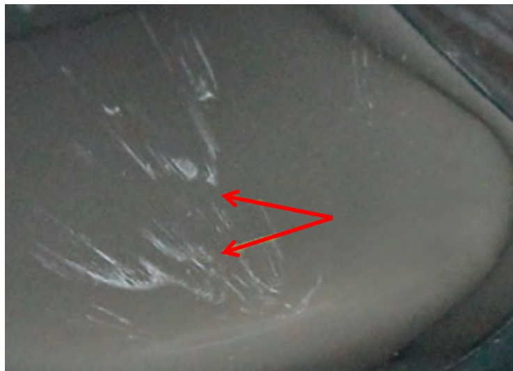
Obr. 23: Stříbrné pruhy na výstřiku. [23]
