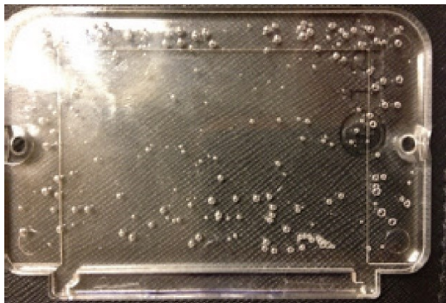
Obr. 20: Bubliny v průhledném výstřiku. [27]
