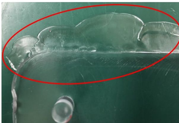
Obr. 25: Přetok na výstřiku v důsledku vysokého vstřikovacího tlaku. [25]
