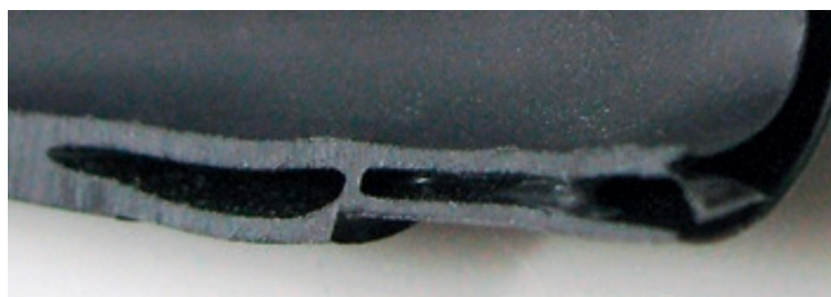
Obr. 21: Bubliny v rozříznutém neprůhledném výstřiku. [23]
