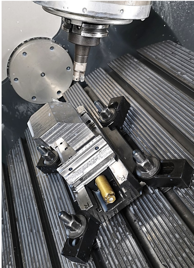
Obr. 78 Dokončená plocha sražení
