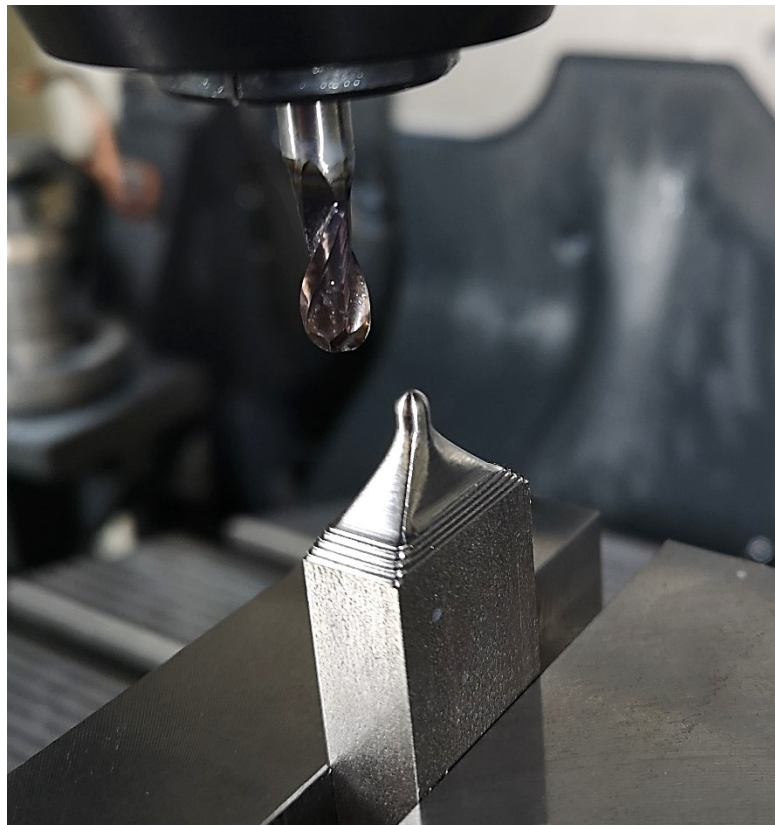
Obr. 84 Dokončení tvarové plochy kulovou frézou
