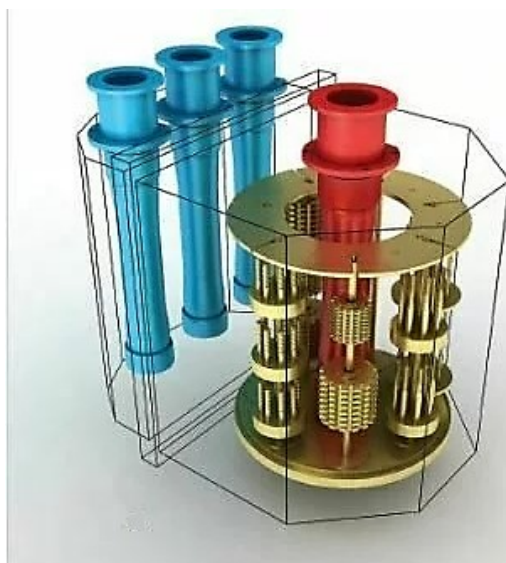
Obr. 24 Rotační držák pro PVD [25]
