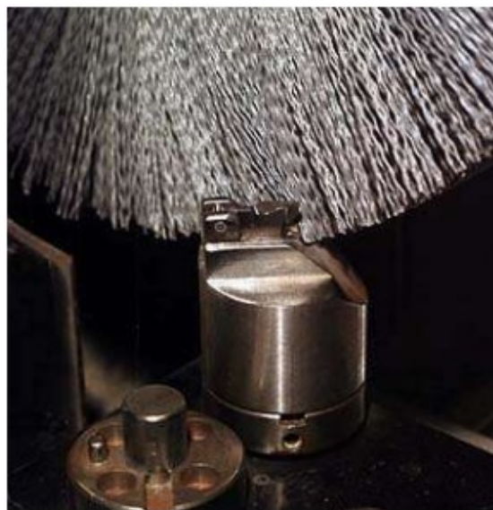
Obr. 20 Úprav řezných hran kartáčem [17]
