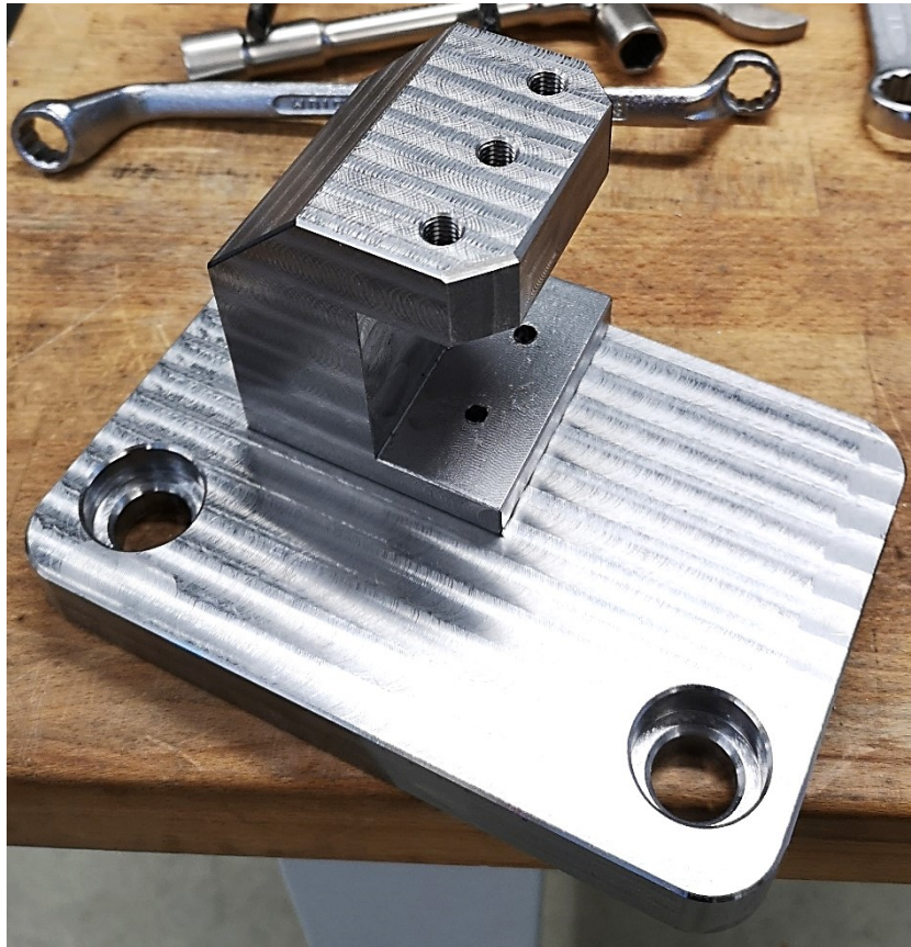
Obr. 79 Vyrobený upínací adaptér položený na základové desce
