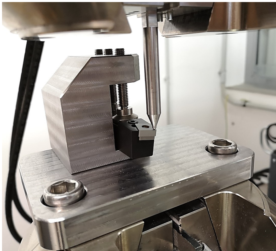
Obr. 101 Upínací přípravek s tlačným trnem při cyklickém testu
