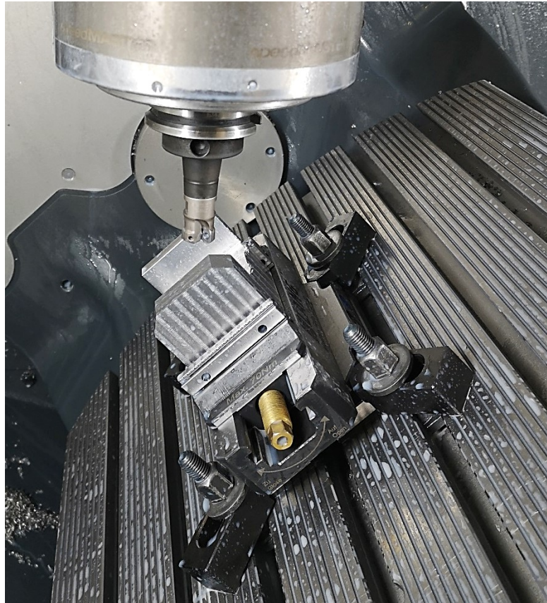
Obr. 73 Dokončení rohů adaptéru
