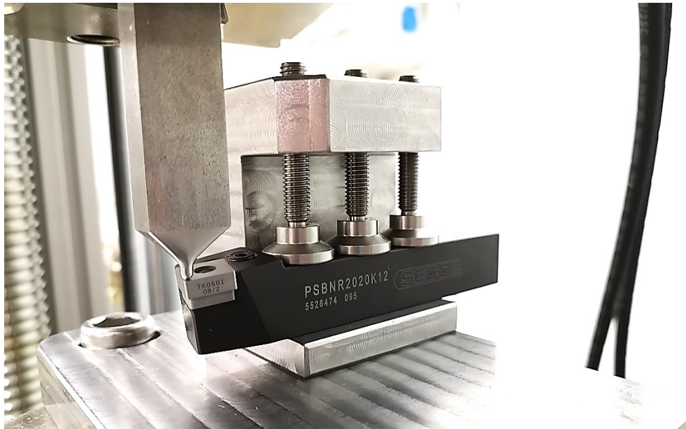
Obr. 87 Sestavený upínací přípravek bez klínu
