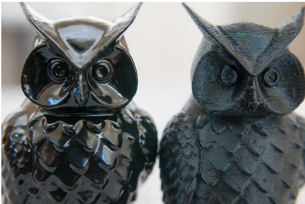
Obr. 22: Výtisk ABS nevyhlazený a vyhlazený acetonovou parou. [34]
