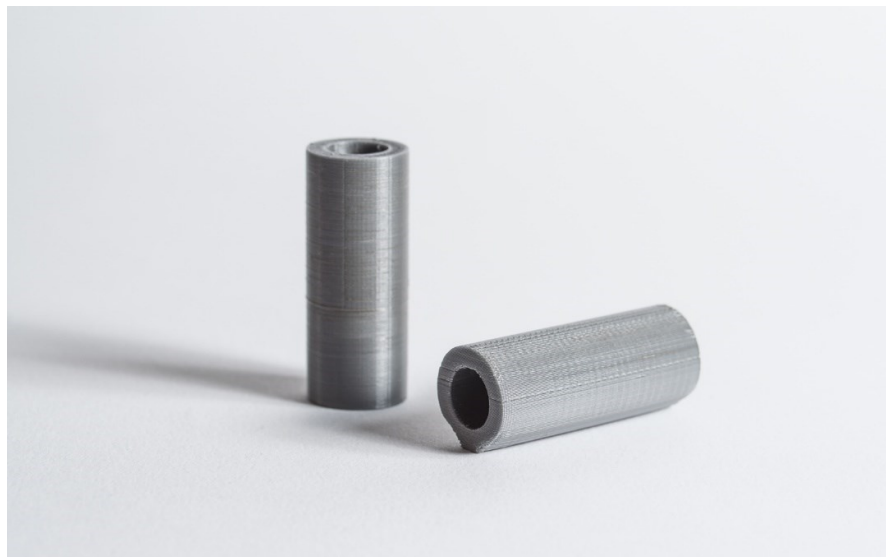
Obr. 17: Válec tištěný horizontálně a vertikálně. [28]
