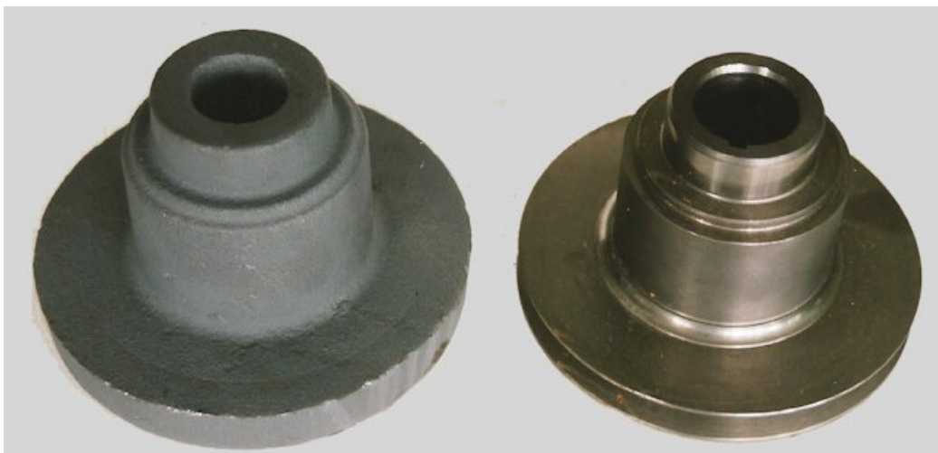
Obr. 1 Rozdíl mezi polotovarem a již obrobeným povrchem [3]
