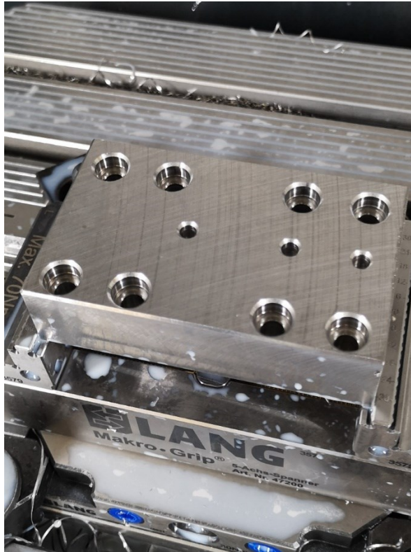
Obr. 53 Dokončené díry z přední strany
