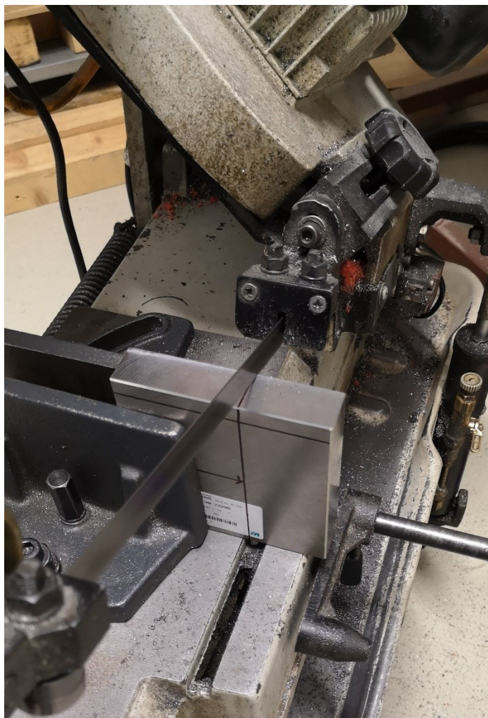
Obr. 50 Zkracování polotovaru před výrobou na CNC frézce
