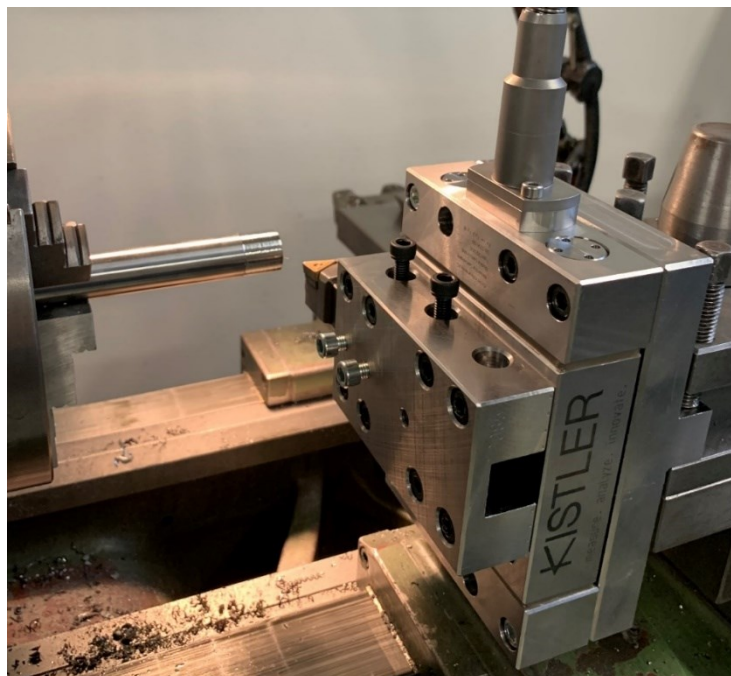
Obr. 55 Složená sestava s nožem připravená na následné měření
