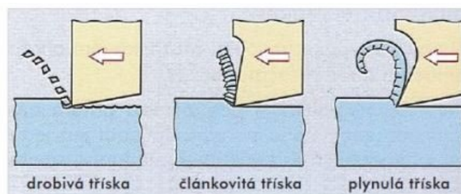
Obr. 3 Možné tvary třísek vznikající při obrábění [8]
