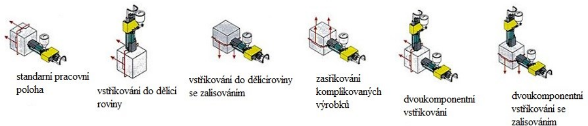
Obr. 9 Možnosti uzavírání formy [5]
