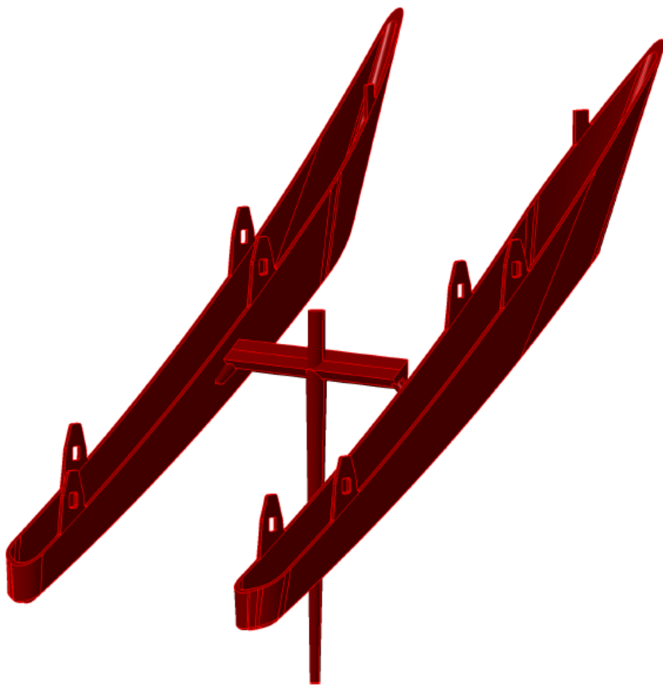
Obr. 20: Vstříkovaný díl s vtokovým zbytkem
