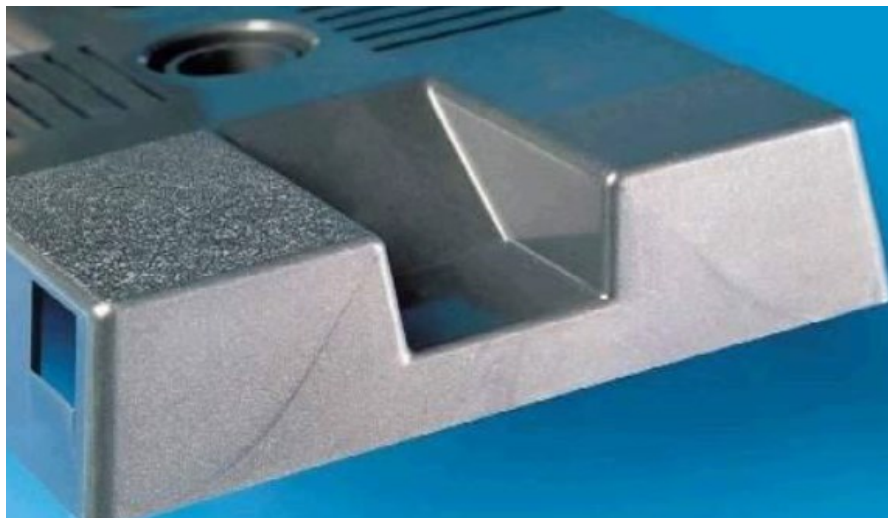
Obr. 9: Studené spoje na výrobku [13]
