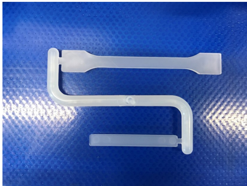
Obrázek 20 - výlisky před oddělením od vtoku
