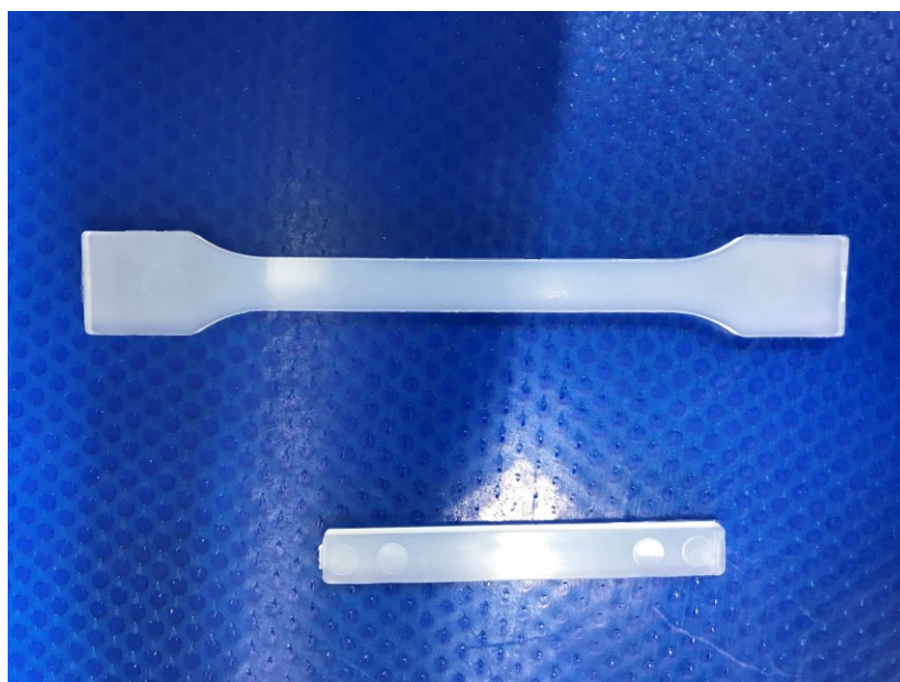
Obrázek 21 - výlisky po oddělení vtoku
