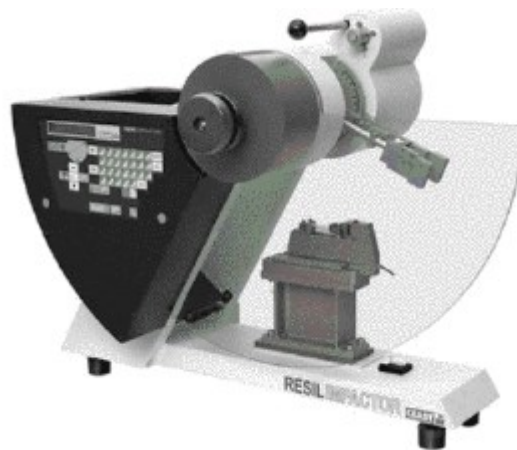
Obrázek 2 - schéma kyvadla rázové zkoušky tahem[9]
