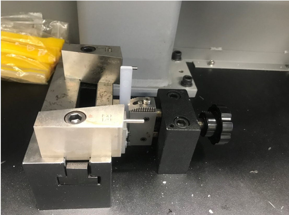
Obrázek 25 - upnutí vzorku podle ISO 180-1
