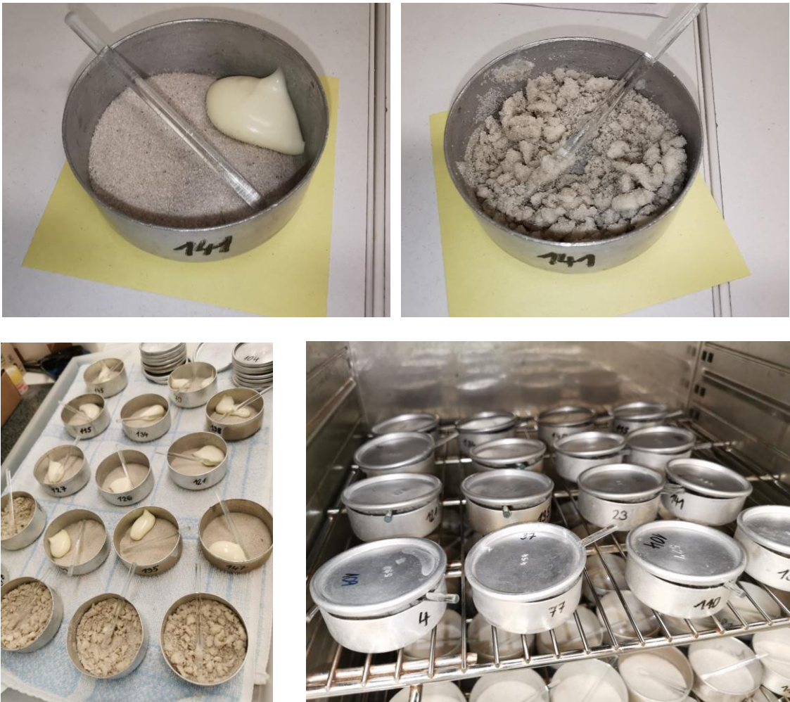
Obrázek 5.: Proces přípravy modelových vzorků ke stanovení celkového obsahu sušiny (vlastní fotografie)
