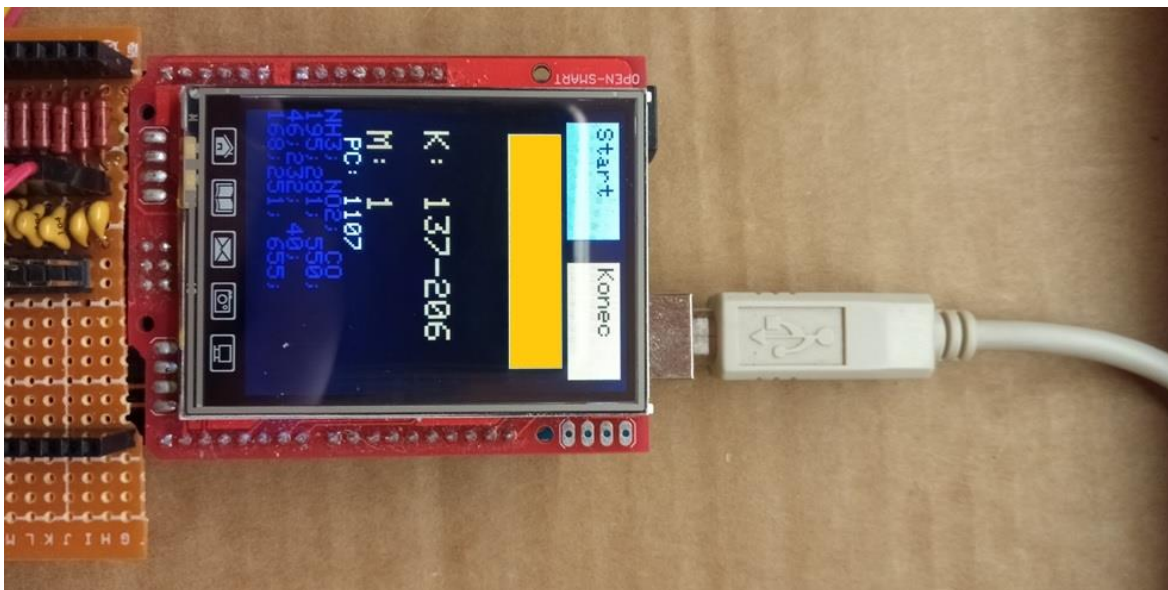
Obrázek 16: Mikrokontrolér s rozsvícenou oranžovou barvou na displeji upozorňuje na to, že se maso může začít mírně kazit. Maso je nutné neprodleně zpracovat.
