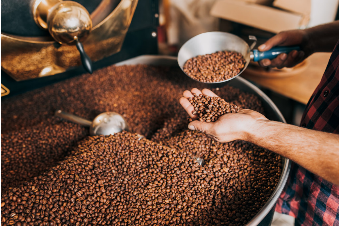
Obrázek 11 Chlazení kávy po pražení (19)
