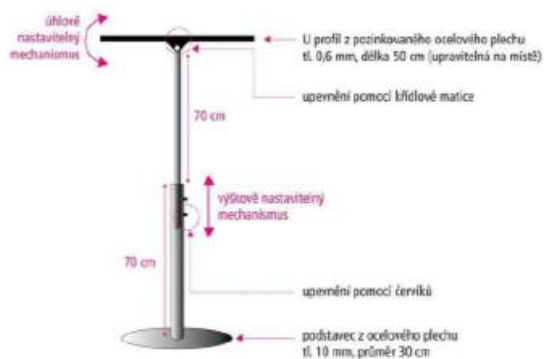
Obr. 51. Schéma technického řešení podstavce k textovému panelu
