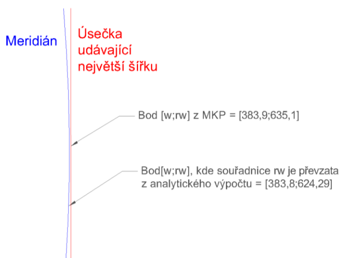
Obr. 43: Detail meridiánu 800/70 R32 vypočteného pomocí MKP
