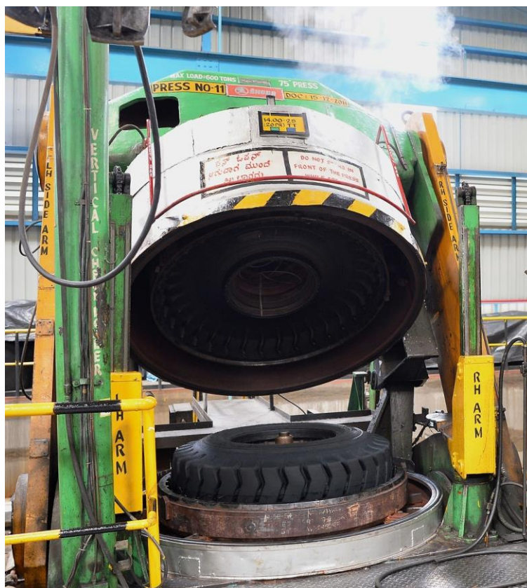
Obr. 3: Pneumatika v otevírající se formě po ukončení lisovacího cyklu
