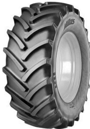
Obr. 18: Zemědělská pneumatika s typickým šípovým dezénem
