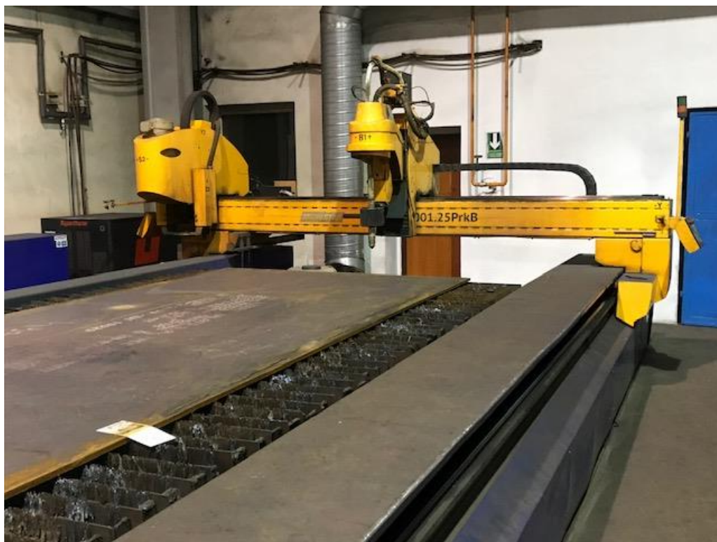
Obrázek 11 Pálicí stroj Microstep (interní zdroj společnosti)
