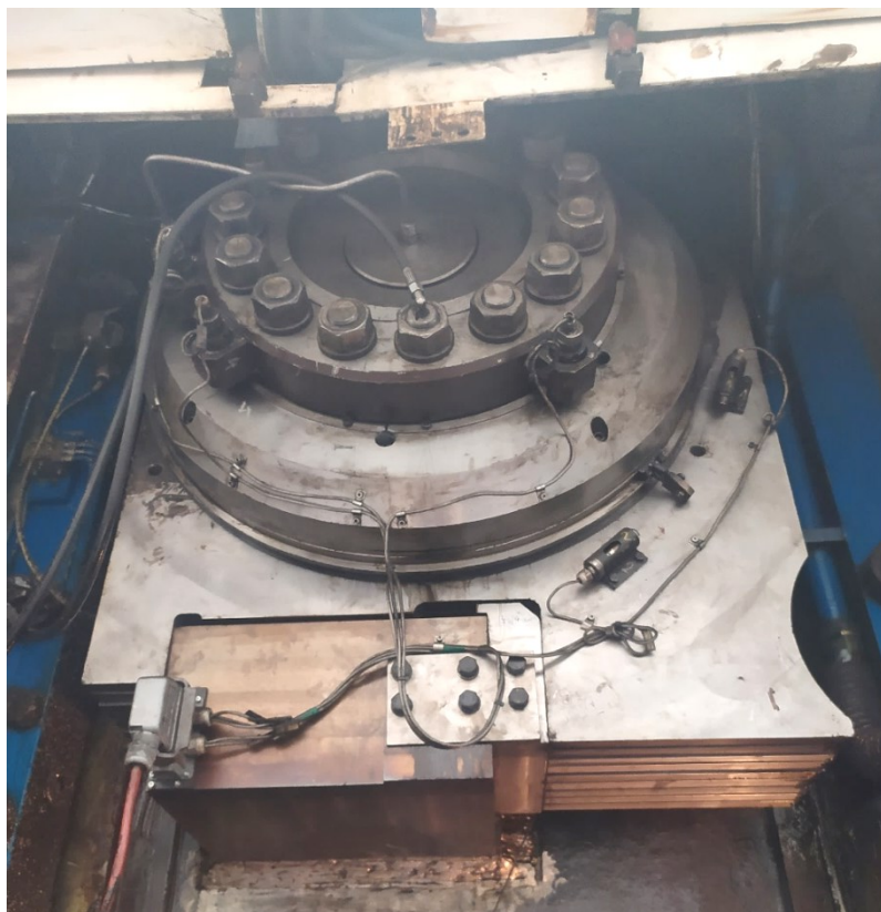
Obrázek 32: Brzda přestavení namontována na stroji
