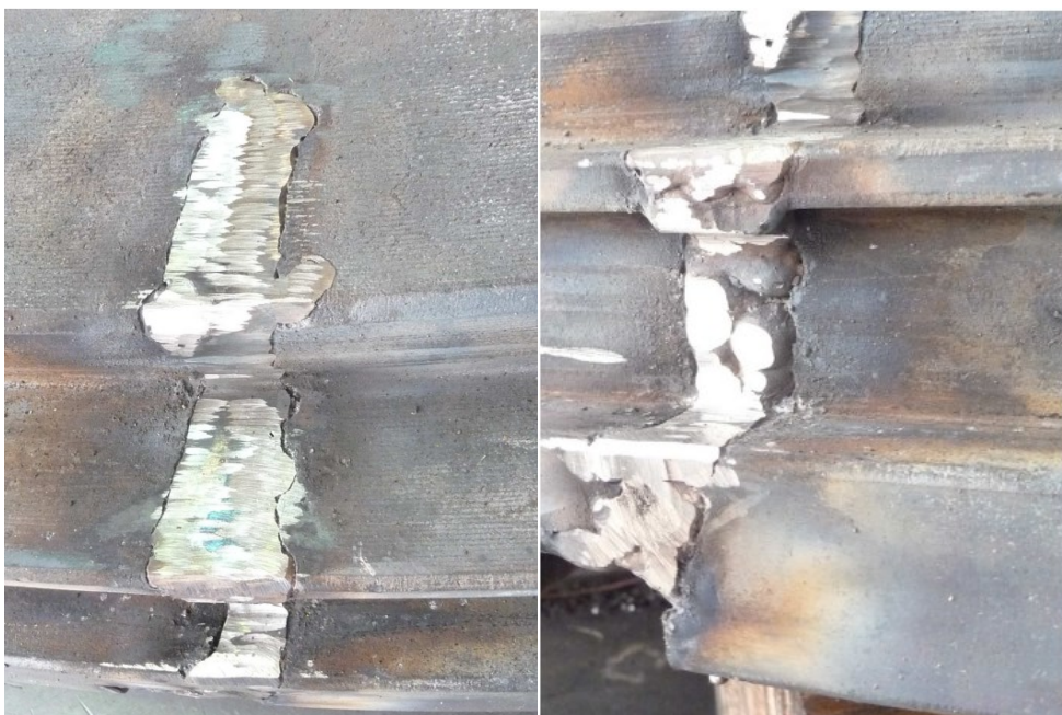
Obrázek 34: Detaily zavařované praskliny
