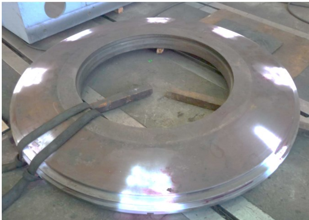
Obrázek 18: Píst spojky s provedenými zkouškami
