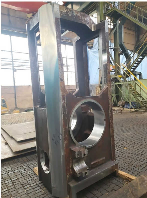
Obrázek 15: Beran s opracovanými lištami a kostkou na mechanické přestavení
