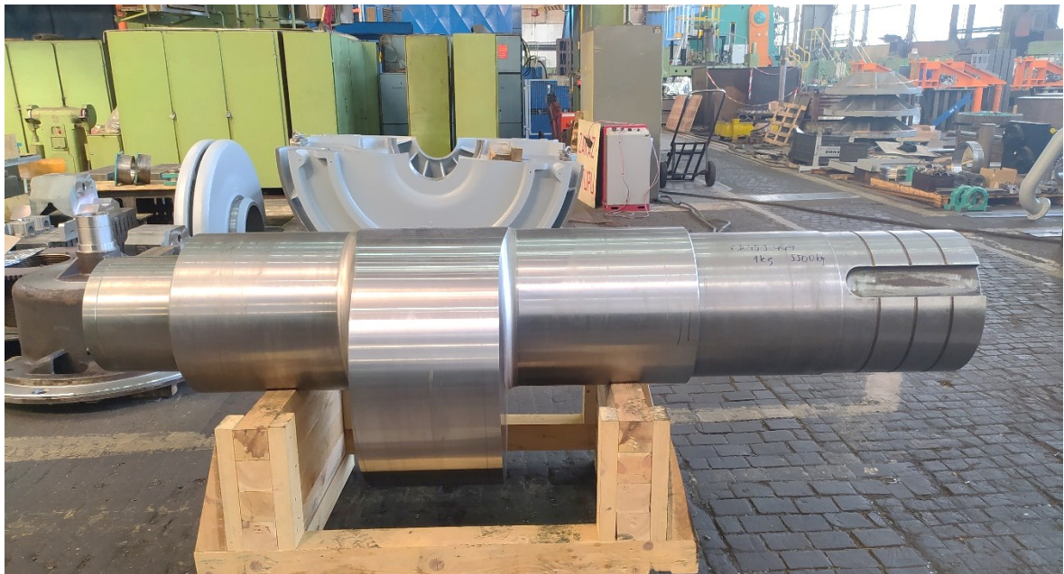
Obrázek 28: Excentrická hřídel připravená na svrtávání
