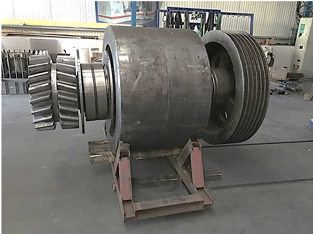
Obrázek 23: Předloha připravena na demontáž
