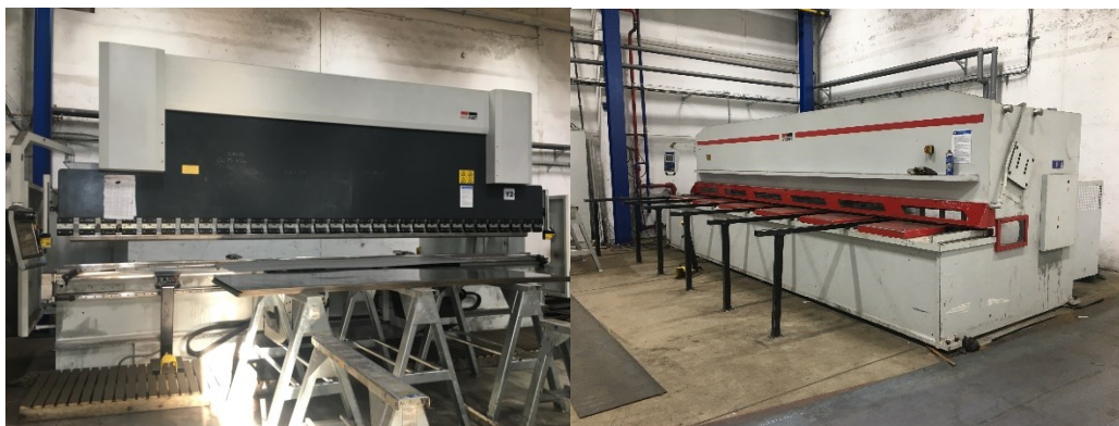
Obr. 19. Stříhání a ohýbaní plechů na hydraulických lisech
