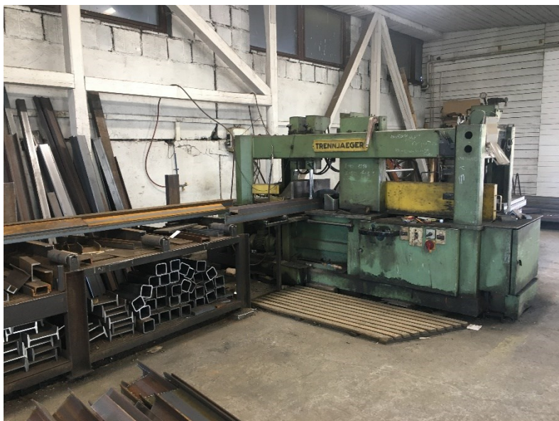
Obr. 20. Řezání válcovaných profilů na kotoučové pile
