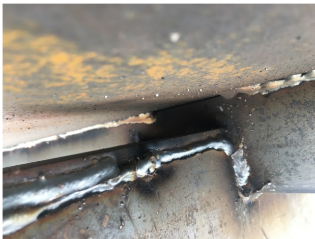
Obr. 24. Kuličky kovu vytvořené při svařování metodou MAG
