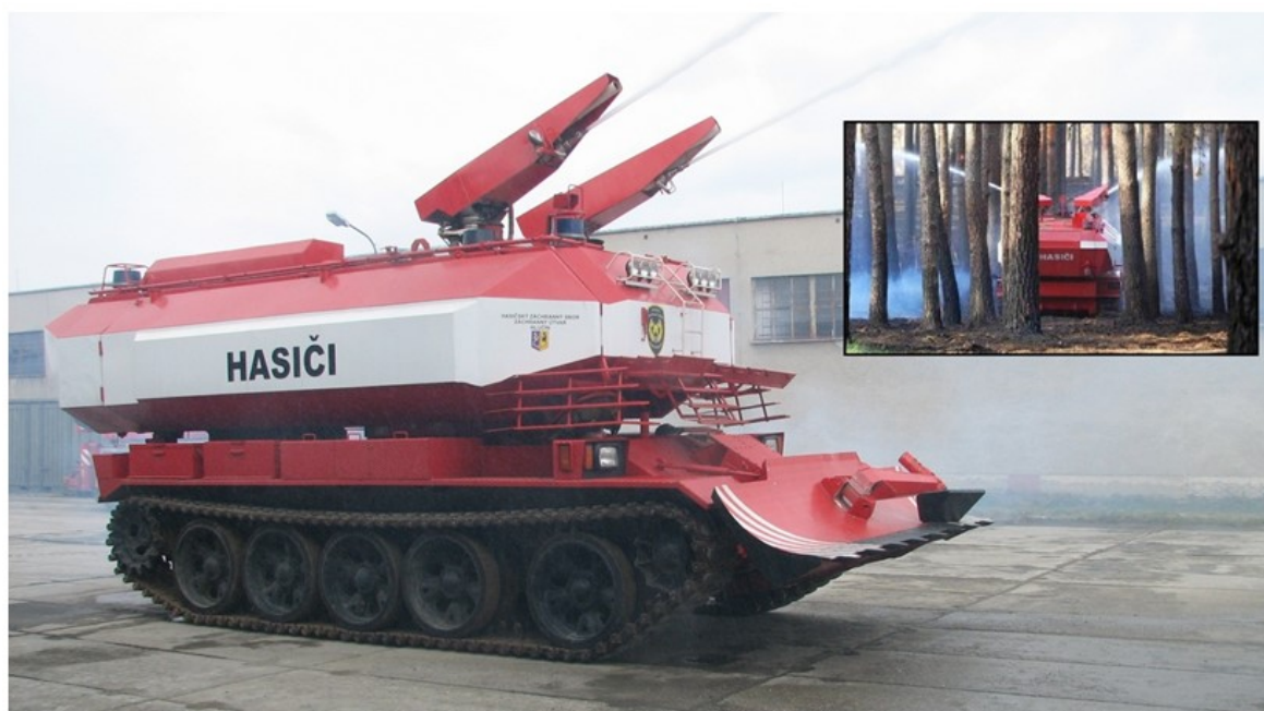
Obrázek 16 Speciální požární pásové vozidlo SPOT-55 Zdroj: [34]
