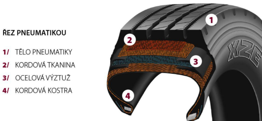
Obr. 11: Řez pneumatikou [19]
