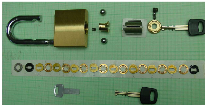
Obrázek 9 Obsah visacího zámku [Vlastní zdroj]
