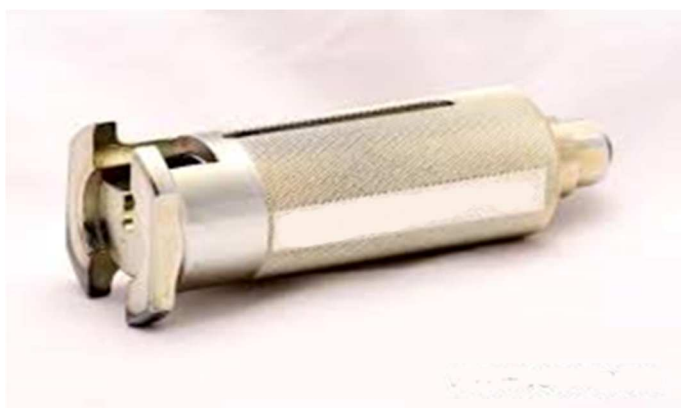
Obrázek 18 Nástroj pro destrukci cylindrické vložky osazené v bezpečnostním kování [12]
