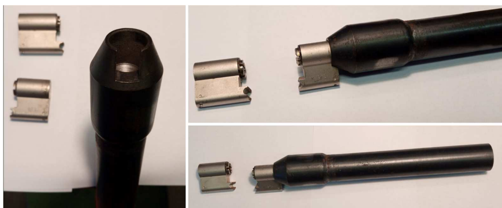
Obrázek 33 Lamač zámkových vložek s rozlomenou zámkovou vložkou [Vlastní zdroj]
