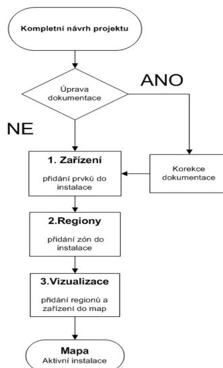
Obr. 16 Rozfázování průběhu instalace
