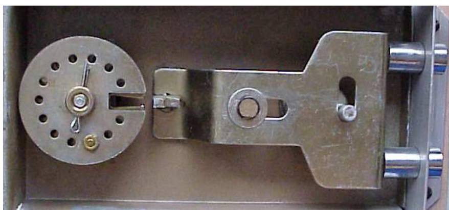
Obrázek 22 Detailní pohled na vnitřní uspořádaní mechanického kombinacniho trezoroveho zamku s klíčovým trezorovým zamkem, nezjisteneho vyrobcе [14]
