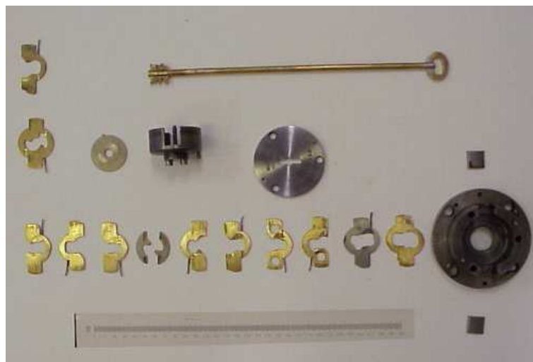
Obrázek 17 Pohled na rozebraný klíčový trezorový zámek, nezjištěného výrobce [14]
