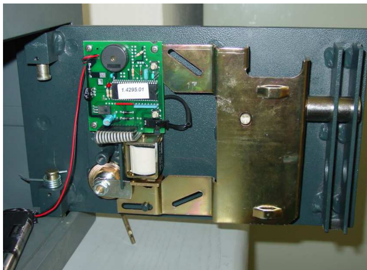
Obrázek 25 Pohled na vnitřní uspořádání elektronického zámku ve stavu odemknuto, nezjištěného výrobce[14]
