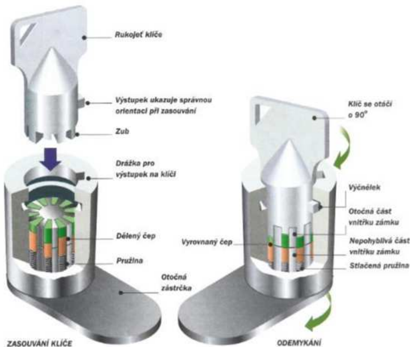
Obrázek 28 Princip funkce Bramahova axiálního zámku [20]
