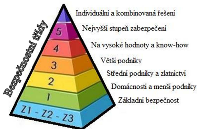
Obrázek 9 Bezpečnostní třídy trezorů [10]
