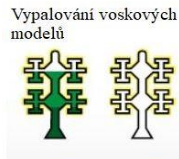
Obrázek 8 Vytavování voskových modelů (interní zdroj)
