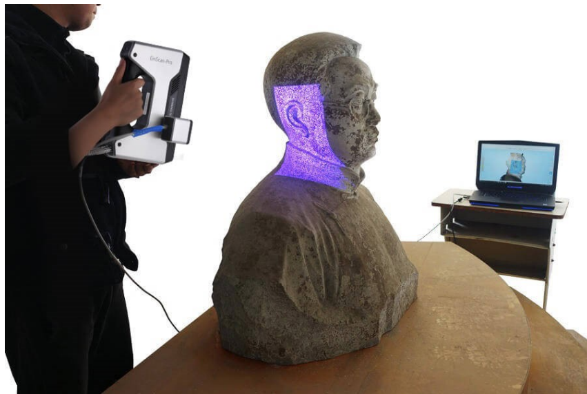
Obr. 1 Skenovanie pomocou 3D skenera [4]
