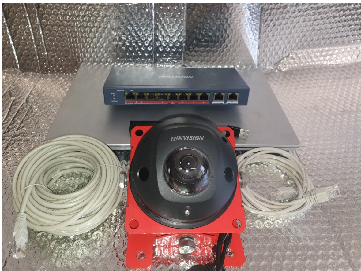
Obr. 18: Modulární systém pro monitorování podvozku (vlastní zpracování)
