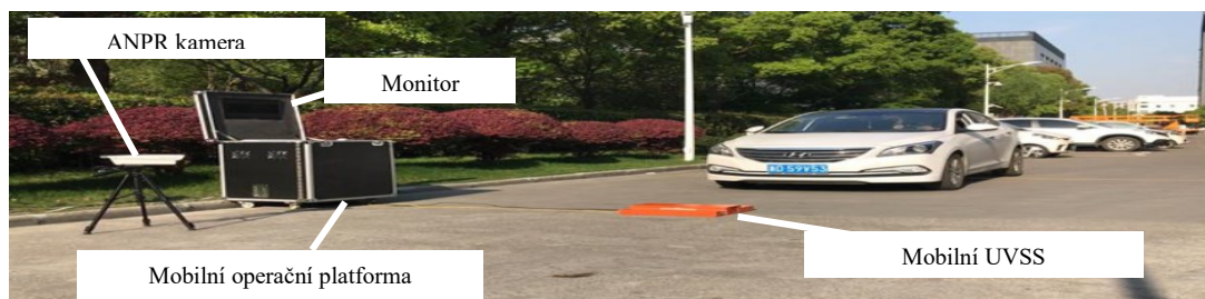
Obr. 8: Popis prvků instalovaného mobilního UVSS od společnosti Hikvision
