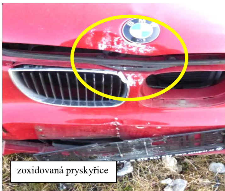
Obr. 2 Přední část poškozeného vozidla BMW, kde se nachází světlé stopy zoxidované pryskyřice. [1]
