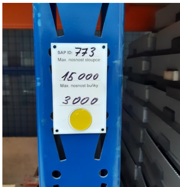
Obr. 12 Příklad revizního štítku regálu, na kterém byla nalezena závada, která ale nebrání v jeho užívání [vlastní]
