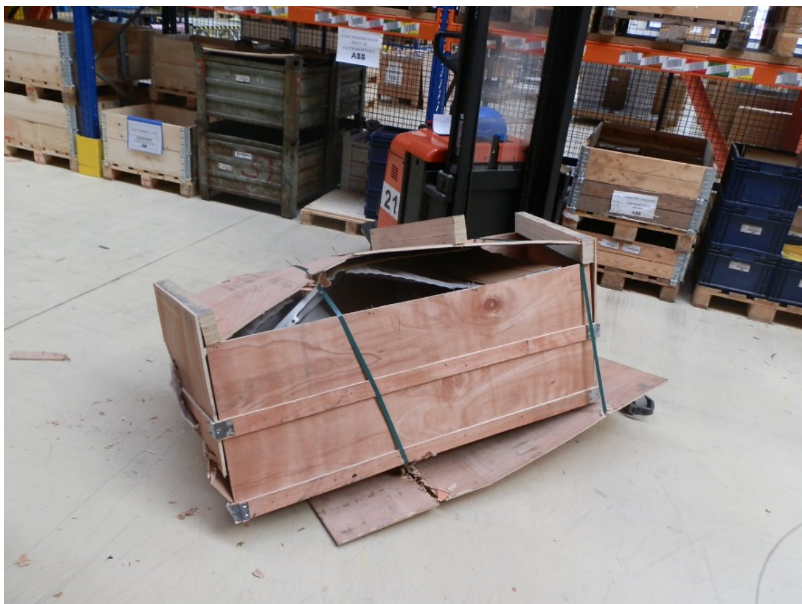
Obr. 7 Špatné balení – do palety se nedalo správně najet VZV a převážila se [vlastní]
