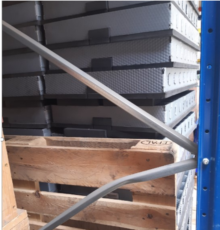
Obr. 13 Závada, která vedla k udělení žlutého štítku na obrázku 11 [vlastní]
