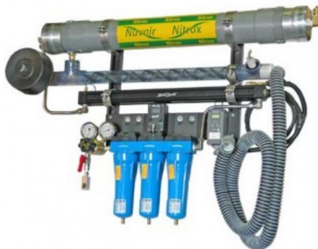
Obrázek 10 Membrána pro produkci Nitroxu [18]
