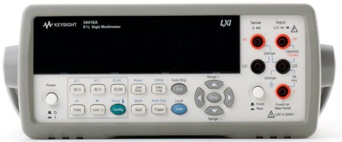
Obrázek 45 – Čelní strana multimetru Agilent 34410 [28]
