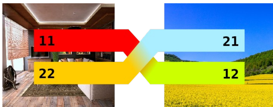
Obrázek 3: Princip rekuperačního výměníku s protiproudem
