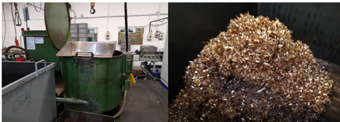
Obrázek 26 Odlučovací zařízení a znečištěné třísky (vlastní zpracování)
