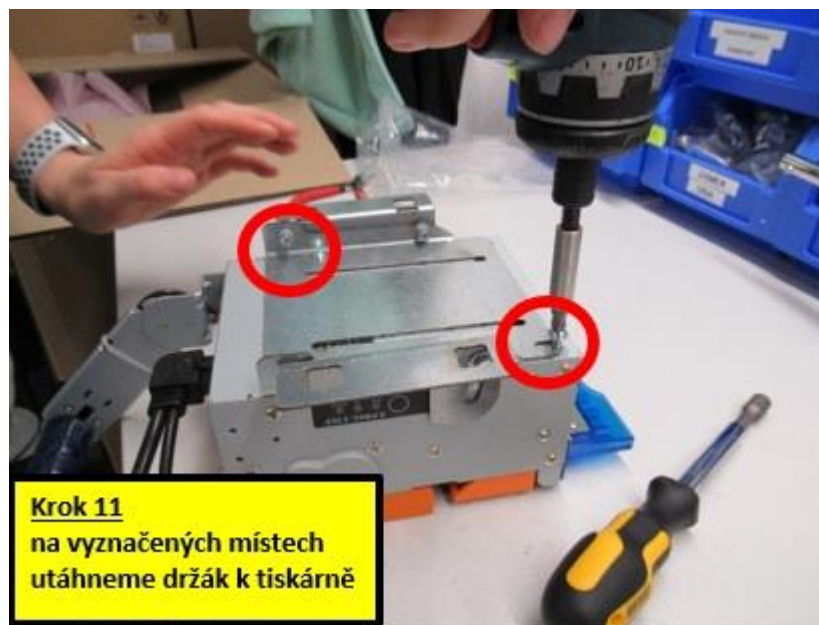
Obrázek 31 Předmontáž tiskárny (vlastní zpracování)
