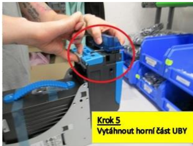
Obrázek 30 Předmontáž akceptoru (vlastní zpracování)
