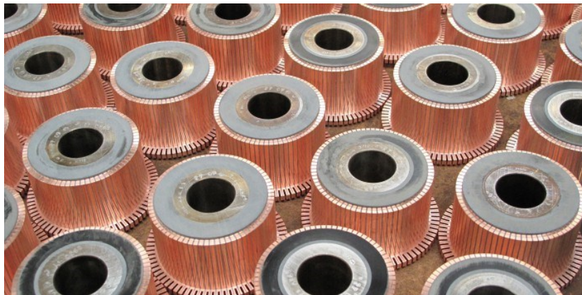
Obr. 5 Lisované komutátory (Lisované komutátory, ©2015)
