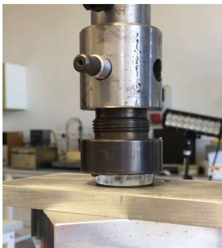
Obr. 25 Vzorek při zatěžování tlakovou silou
