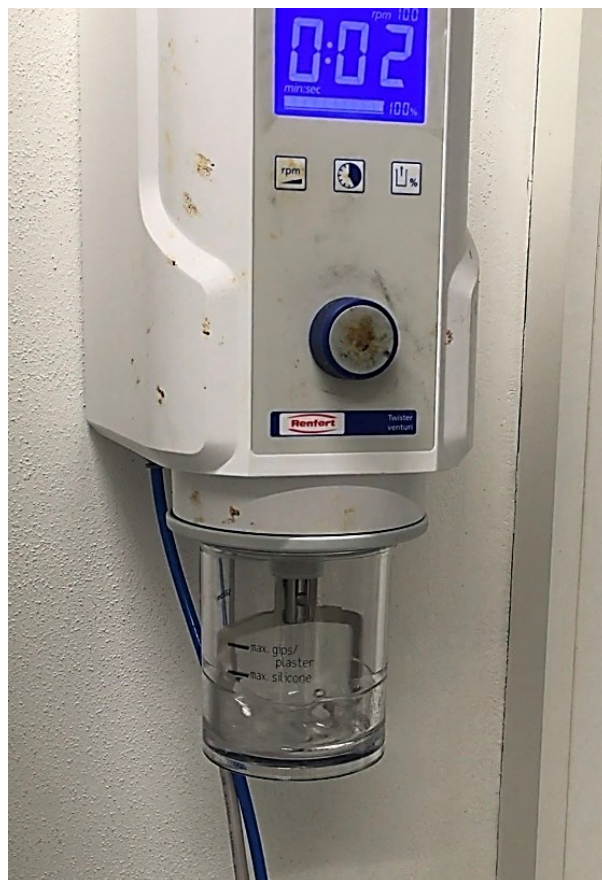
Obr. 20 Míchání Sylgardu S184 s vytvrzovacím činidlem
