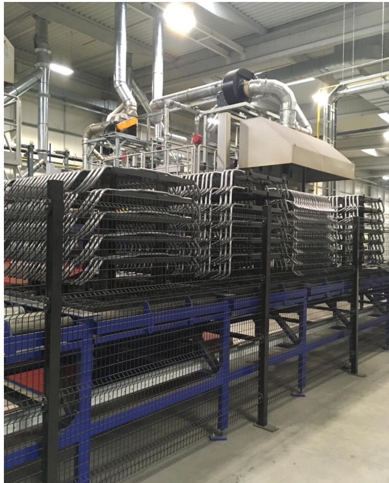
Obr. č.29 Geštel-uložení vzorků při tepelném zpracování
