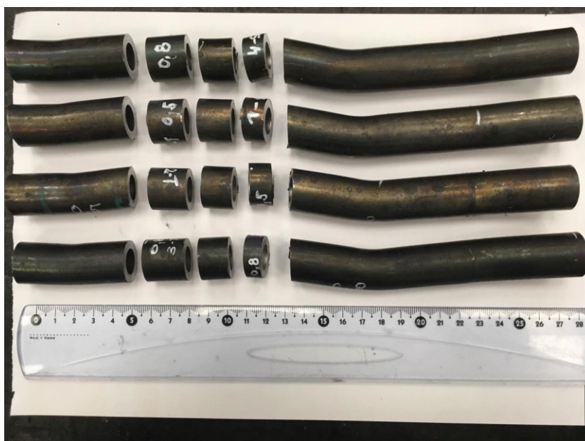
Obr. č.45 Vyříznuté prstýnky pro zkoušku tvrdost a složení povrchové vrstvy
