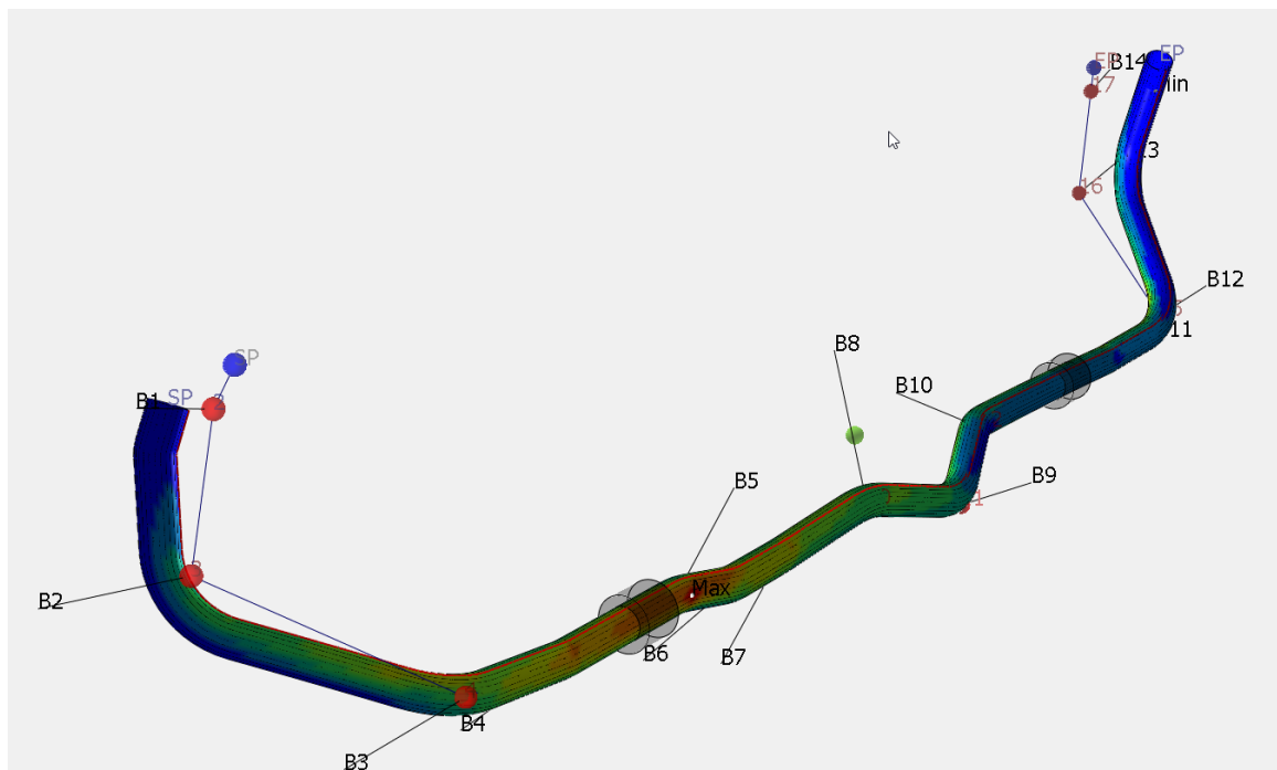
Obr. č.39 Analýza místa předpokládaného lomu=B5 Max
