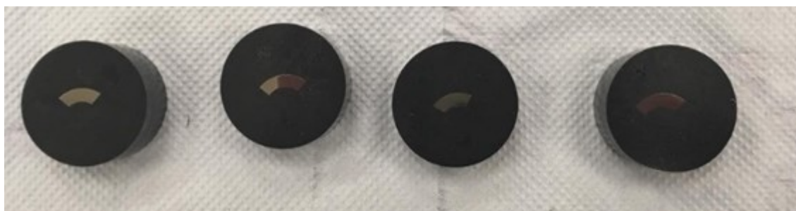
Obr. č.51 Zalisované vzorky pro zkoušku složení povrchové vrstvy
