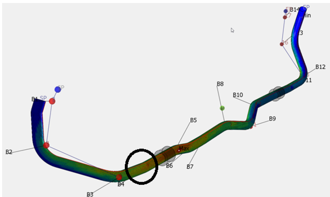
Obr. č.57 Znárodněná oblast 4.ohybu u stabilizátoru
