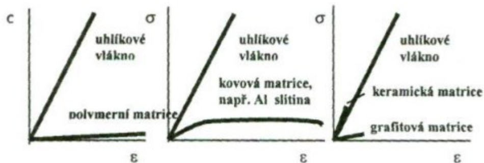
Obr. 17 Závislost napětí na poměrném prodloužení pro uhlíkové vlákno a různé druhy matric [19]
