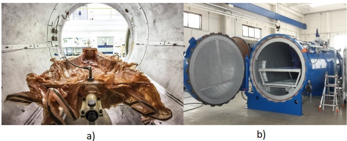
Obrázek 19: a) forma uvnitř autoklávu, b) pohled na Autokláv [42, 43]
