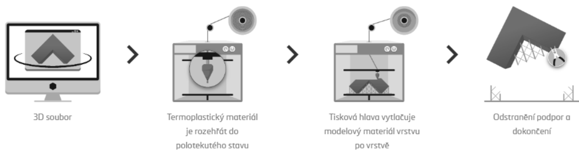
Obr. 2 Postup výroby objektu technologií FDM [7]
