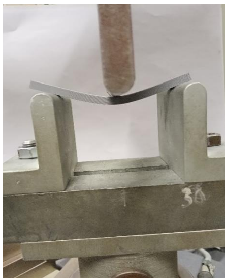
Obr. 15 Ohybová zkouška tělíska
