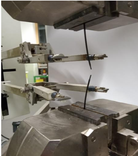
Obr. 13 Filament po tahové zkoušce
