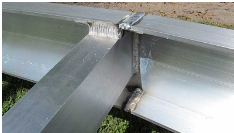
Obr. 5 Svařené hliníkové profily. [9]
