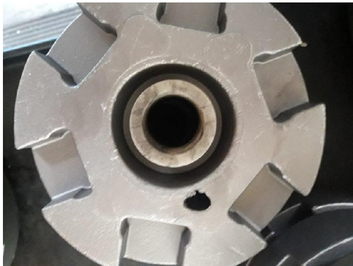
Obrázek 32 Defektní spojka (interní zdroj)
