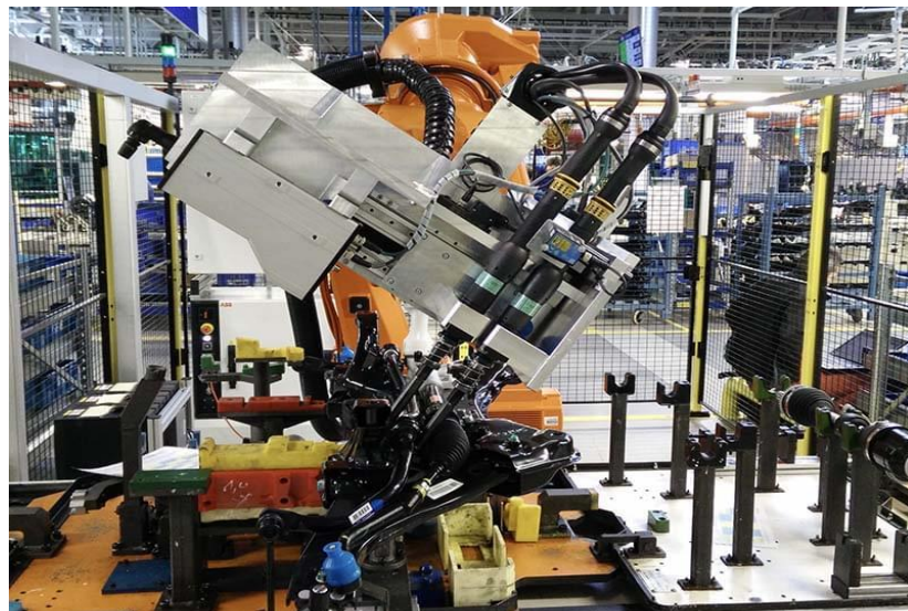
Obrázek 7 – Ukázka zrealizovaného projektu – Automatické robotické pracoviště pro utahování šroubů stabilizátoru přední nápravy (zdroj: KVM Quarda s.r.o.)
