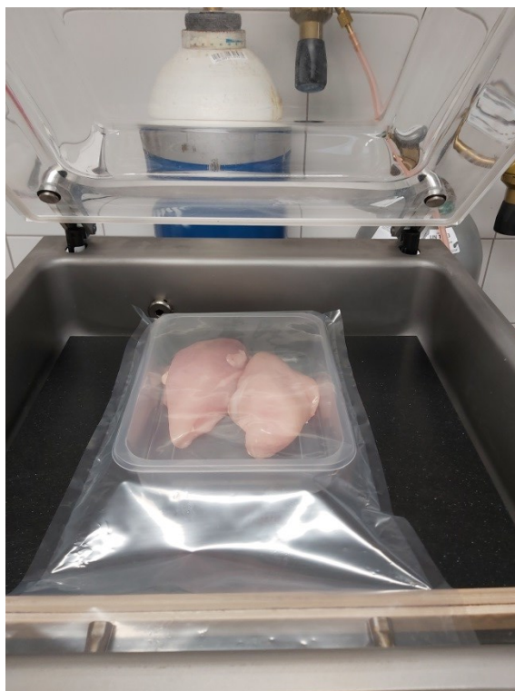
Obr.24. Balení kuřecího masa do modifikované atmosféry
