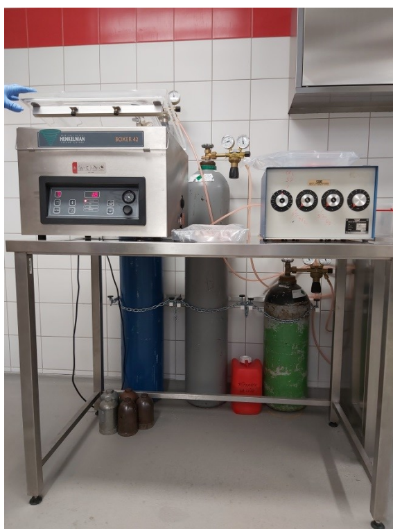
Obr.27. Směšovací zařízení pro balení masa
