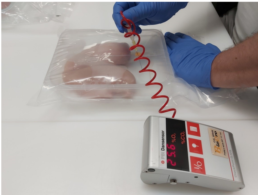
Obr.26. Analýza složení plynů kontrolního vzorku balení masa
