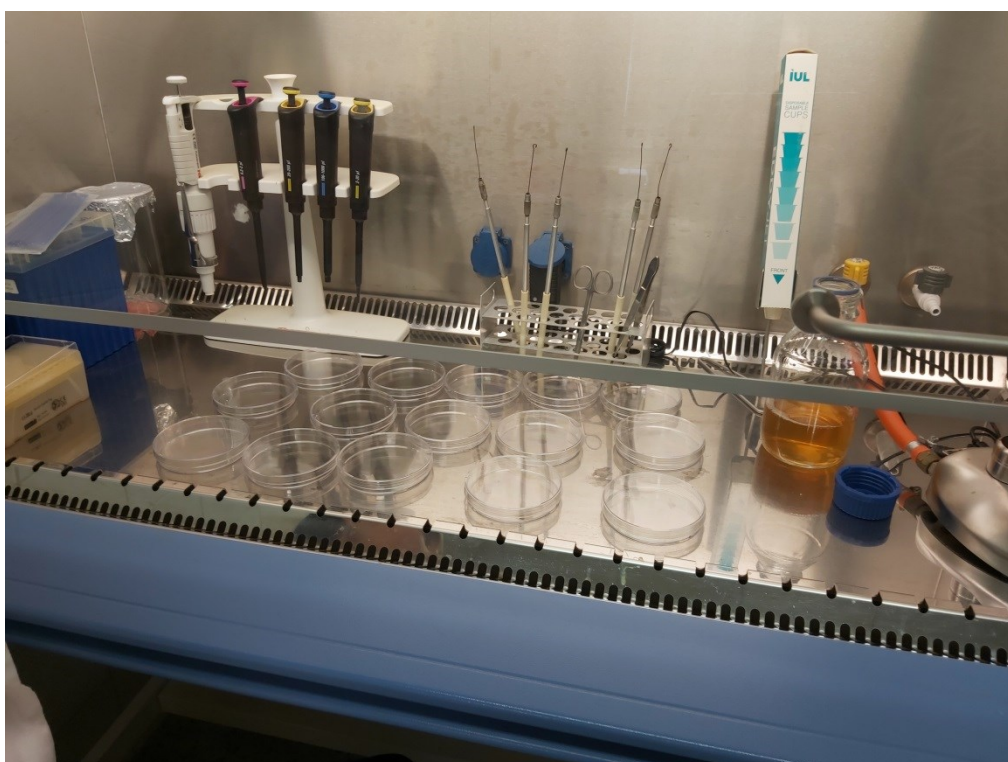
Obr.29. Hazard box s pomůckami pro kultivaci vzorků
