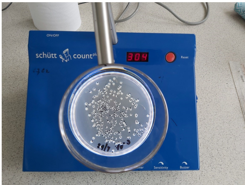
Obr.30. Odečet celkového počtu mikroorganismů na PCA agaru
