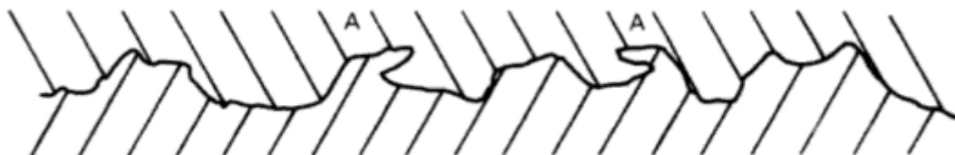
Obrázek 14. Znázorňuje prorůstání mezi povrchem dvou materiálů [15].
