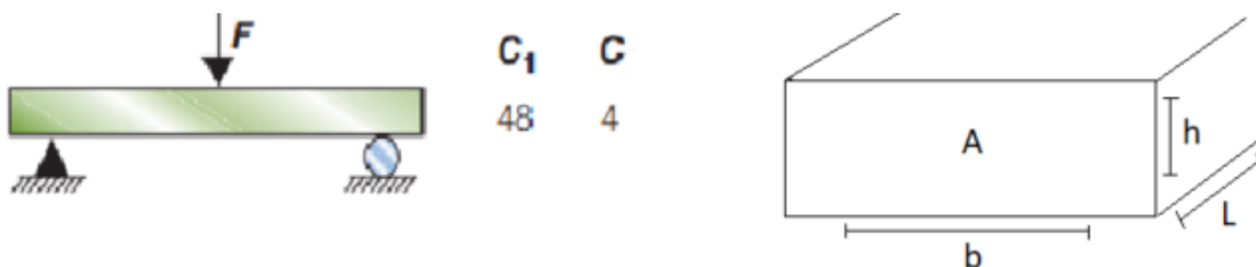
Obrázek 34 Ohybové zatížení panelu s konstanty C_1 s hodnotou 48 a C s hodnotou 4
